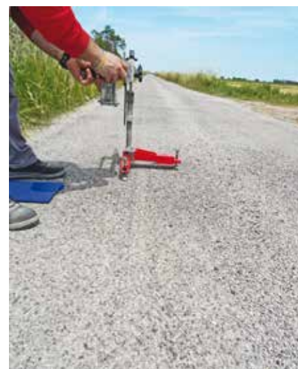
5A, 5B e 5C. Alcune delle prove in sito eseguite su trattamento superficiale a un anno dalla posa in opera: la misura della resistenza all'attrito radente (microrugosità) con skid tester (5B e 5C) e quella della rugosità della macrotessitura (5A)
