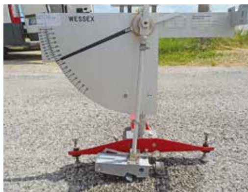
5A, 5B e 5C. Alcune delle prove in sito eseguite su trattamento superficiale a un anno dalla posa in opera: la misura della resistenza all'attrito radente (microrugosità) con skid tester (5B e 5C) e quella della rugosità della macrotessitura (5A)
