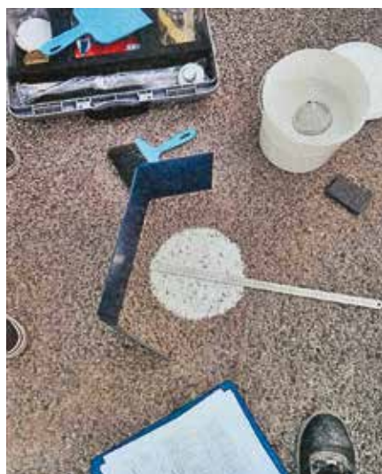
5A, 5B e 5C. Alcune delle prove in sito eseguite su trattamento superficiale a un anno dalla posa in opera: la misura della resistenza all'attrito radente (microrugosità) con skid tester (5B e 5C) e quella della rugosità della macrotessitura (5A)
