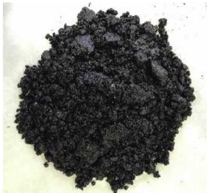
Miscela contenente il 100% di fresato e BITCOLD RAP-100 dosato al 3%
